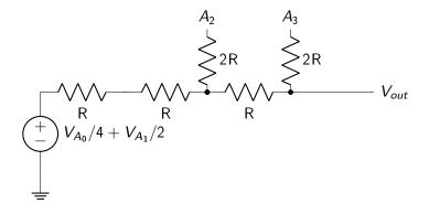
$$\underbrace{ \begin{array}{c} & & \\ + \\ - \\ - \\ \end{array} }^{\mathsf{N}} V_{A_0} / 16 + V_{A_1} / 8 + V_{A_2} / 4 + V_{A_3} / 2$$
